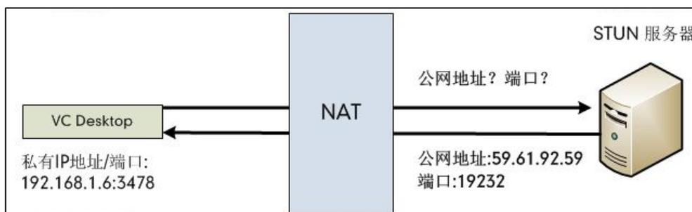
抓包可以看到 Yealink VC Desktop for Mac 向 STUN 服务器发送 Binding 请求 ,STUN 服务器回复映射的地址和端口: Binding Success Response
